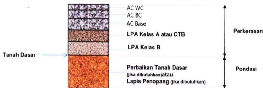
Struktur Perkerasan Lentur (Lalu Lintas Berat) pada Permukaan Tanah Asli (At Grade)
