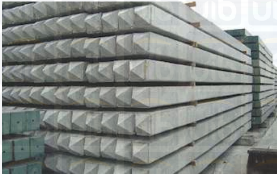
Gambar 2.4 : Tiang Pancang Beton
