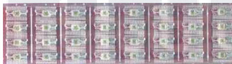
Gambar 3.19 Leadframe sebelum diberi compound .
