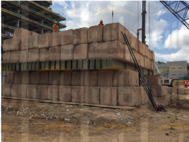
Gambar 4.6 Penyusunan beton untuk Loading Test , sumber : gambar lapangan
