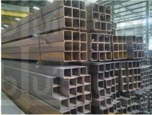
Gambar 2.17 Besi hollow. sumber : gambar lapangan
