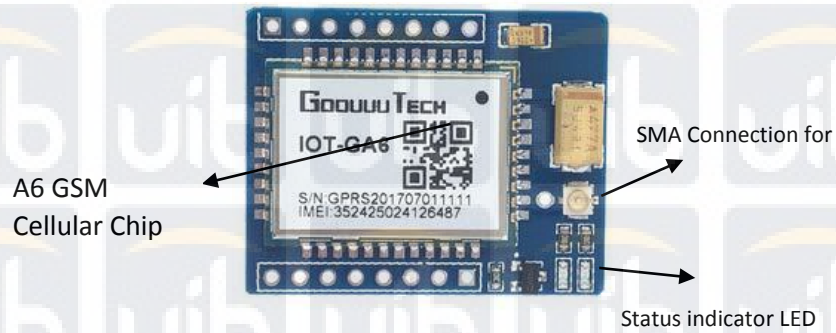
Gambar 2 . 28 Komponen pada mini gsm a6
